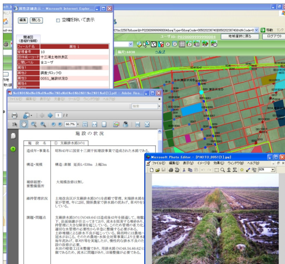
用排水路の現地調査にGPS端末を活用し、水土里情報システムにデータを取り込み後の表示イメージ
